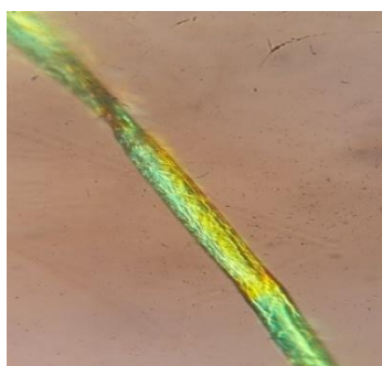
2-rasm. Yuvilgan ingichka tolali "Surxon-104" navli paxta tolasining oq nur (A) va qizil nur (B) ostidagi tasviri
